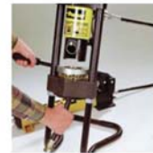
6. Preßstempel in Preßstellung arretieren. Durch Pumpen Druck aufbauen bis der Backenring voll auf der Grundplatte aufliegt.
