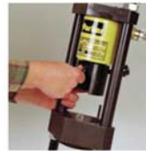
2. Arretierung lösen und Preßstempel nach hinten schwenken.
