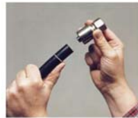
1. Länge der Fassung am Schlauchende markieren. Armatur auf den No-Skive Schlauch bis zur Markierung aufschieben.
