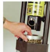
5. Backenring entsprechend der Schlauchtype auf die Backensegmente auflegen.
