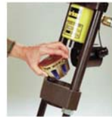
3. Backensatz einlegen und auf gleichmäßige Verteilung der Backensegmente achten.
