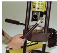
7. Druck entlasten (Flügelmutter am Pumpenausgang) und fertige Schlauchleitung entnehmen.
