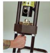
4. Vormontierten Schlauch von unten in den Preßbackensatz schieben und die Armatur auf den Backenschlag aufsetzen.
